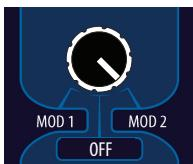
Поверните переключатель ВКЛ/ВыКЛ в положение Режим 2. Когда устройство включено, прозвучит звуковой сигнал. После, примерно через 10 секунд, устройство будет готово для использования с активным звуковым предупреждением.
