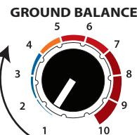
Переместите «БАЛАНС ГРУНТА» в положение 1. Перемещайте катушку слева направо на 5 см над землей. Если устройство воспринимает любое вмешательство, повысьте уровень баланс грунта с небольшим шагом чтобы удалить его, одновременно двигая катушкой. Оставьте значение параметра, когда звук выключается. Теперь, ваш баланс грунта завершен.
