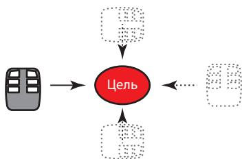
Чтобы определить размер мишени, отметьте точки, когда вы получаете сигнал с четырех сторон.
