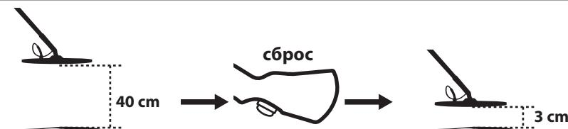
Поднимите катушку на 40 см над землей. Теперь, держа катушку параллельно земле, нажмите кнопку сброса и опустите катушку до 3 см.
