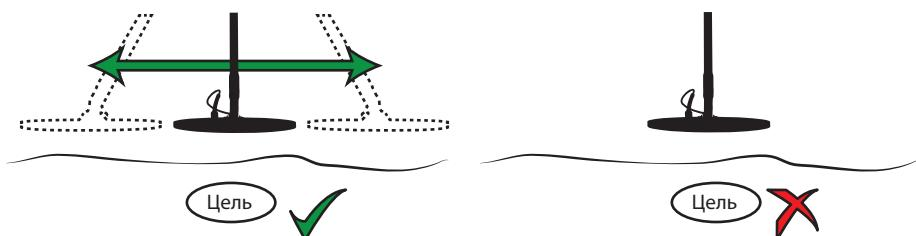
Режим 2 является системой, которая действует в соответствии с принципом движения. Таким образом, катушка должна быть в постоянном движении для того, чтобы устройство обнаруживала металлы. Так как устройство работает на принципе автоматического сброса, если вы еще держите катушку над целью, он не будет обнаруживать металл.
