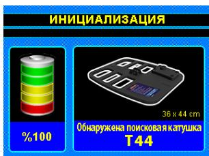
Устройство автоматически во время включения определяет катушку, которая подключена к нему и это будет показано на экране. Если подключенная катушка не соответствует выбранному режиму, это будет указано на экране в виде предупреждения "СБОЙ КАТУШКИ". Кроме того, данные о состоянии батареи также отображаются на экране.
