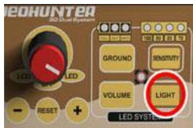
кнопку «СВЕТ» после включения устройства для регулировки уровня яркости. При нажатии этой кнопки в середине загорается светодиод, показывая, что он находится в режиме регулировки.
